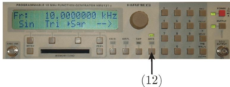
Figura 3.10: Fotografía del generador de funciones HAMEG HM-81131-2 donde se ha marcado el control (12) Pulsador de selección del offset.
