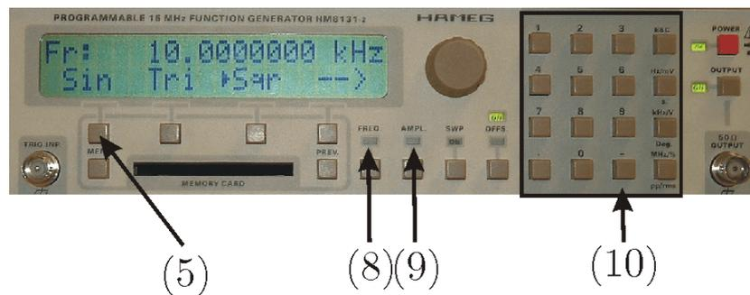
Figura 3.2: Fotografía del generador de funciones donde se han marcado los siguientes controles: (5) Selección señal sinusoidal, (8) Selección de la frecuencia (9) Selección de amplitud y (10) Teclado para introducir los distintos valores.
