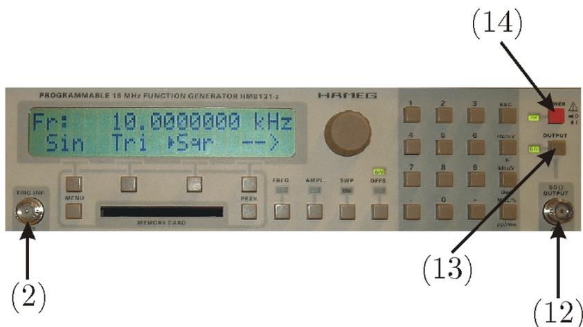
Figura 3.1: Fotografía del generador de funciones donde se han marcado los siguientes controles: (14) Encendido y apagado, (13) Activación de la señal de salida, (12) Conector BNC de salida y (2) Conector BNC de entrada de disparo.
